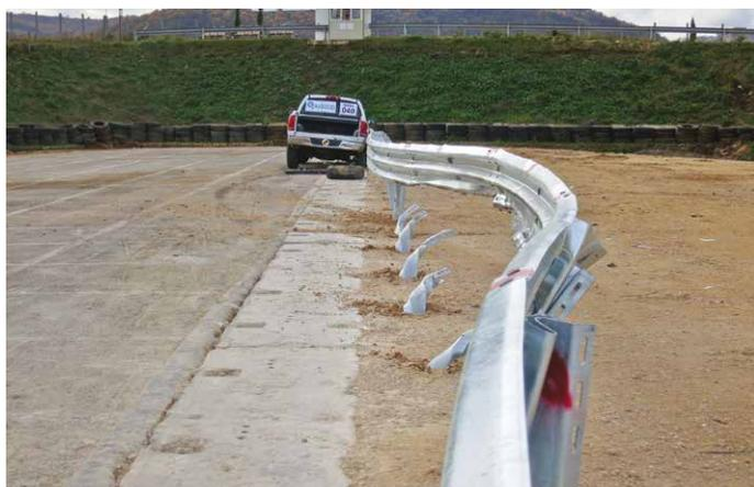
**3A e 3B.** Una barriera installata su terreno del Campo Prove (3A) e suo comportamento durante una prova di crash (3B)
